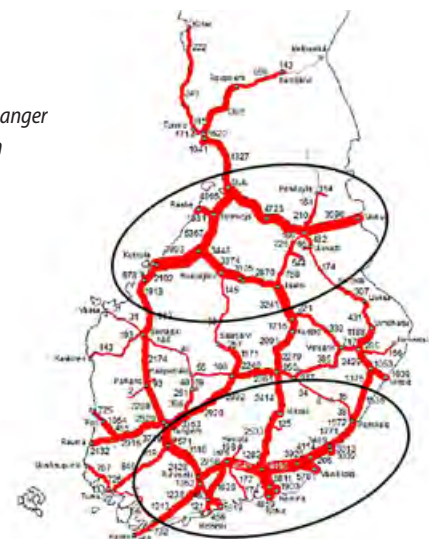
Bild 10. Godstrafikens transportströmmar (Trafikverket 2013)
